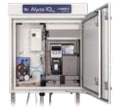
Analyseautomat zur Überwachung der Ammoniumkonzentration in Kläranlagen und Flüssen - bis 150 mg/l, mit automatischer Messbereichsumschaltung und Trigger-Messung.
